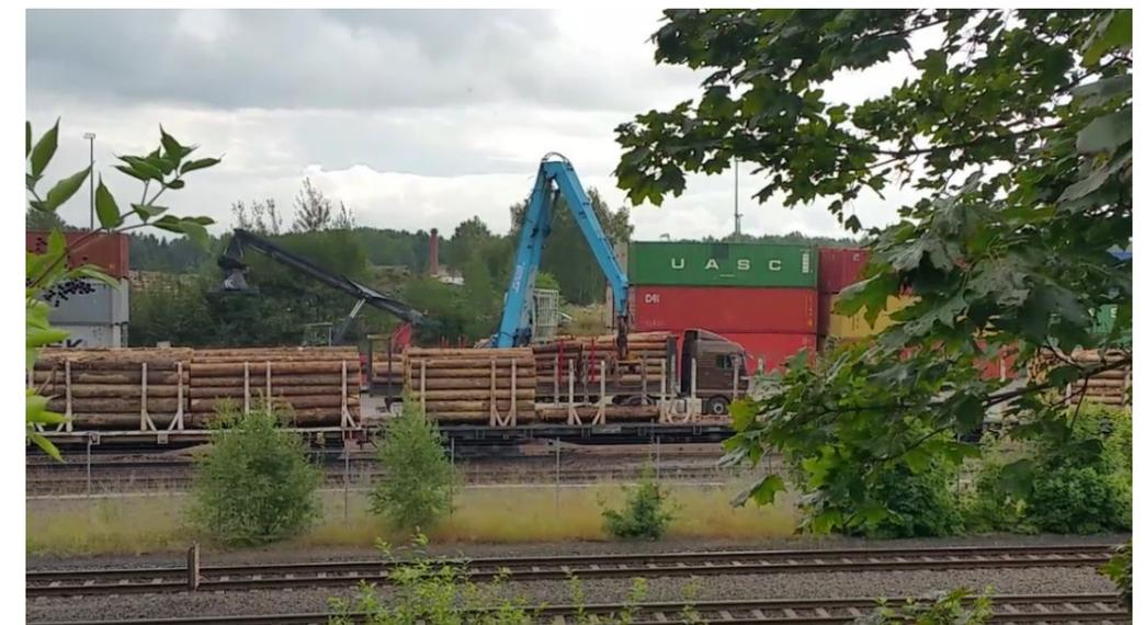
Abbildung 13: Entladung Rundholz von Zug auf LKW mittels Bagger /31/
