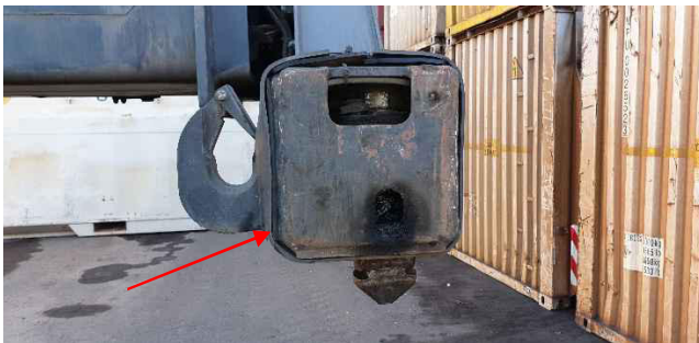
Abbildung 10: Greiferende mit Elastomerstreifen
