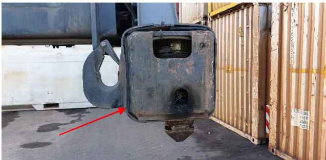
Abbildung 10: Greiferende mit Elastomerstreifen
